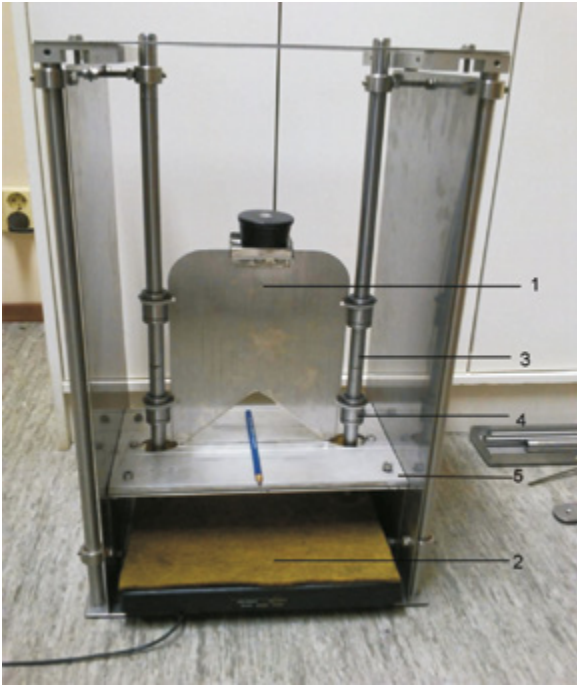
Joonis 2. Katseseade liha löikeenergia määramiseks LGI meetodiga (1- lõiketera, 2 - jõuanduri platvorm, 3 - juhtvardad, 4 - liuglaager, 5-lõikelaud)
