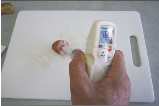
Foto 2. Lihase pH-väärtuse määramine seadmega Testo 205 (S. Sild)
